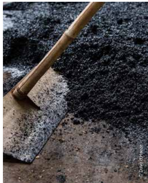
Las cáscaras de café convertidas en biocarbón, un biocombustible, en Viet Nam.
